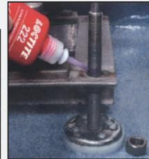
Фиксатор резьбовых соединений Loctite предотвращает ослабления и обеспечивает защиту соединений от вибрации и ударных нагрузок. Благодаря низкой вязкости, они полностью заполняют зазоры между контактирующими резьбовыми частями деталей соединения. Резьбовые фиксаторы Loctite могут использоваться для широкого спектра применений.
