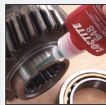
Вал-втулочные фиксаторы Loctite предназначены для жесткой установки подшипников, втулок и прочих цилиндрических деталей в свои гнезда или на валы. При этом повышается несущая способность узла и обеспечивается равномерное распределение нагрузки на детали, исключая возможность образования фреттинг-коррозии. Наносимые в жидком состоянии, данные продукты обеспечивают контакт цилиндрических поверхностей по всей площади, устраняя необходимость замены дорогостоящих деталей и механической обработки.
