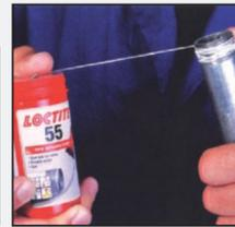
Резьбовые герметики Loctite, производятся как в виде жидких составов, так и в виде уплотнительной нити, предотвращая утечку газов и жидкостей. Резьбовые герметики Loctite заполняют зазоры между резьбовыми деталями, при этом низкое давление допускает подачу сразу после сборки соединения. По окончании полимеризации прочность герметиков превышает прочность большинства трубопроводов, в которых они применяются.
